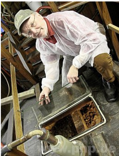
In vier Anlagen wird im Hause Kriegl Essig produziert. Peter Kriegl zeigt die Buchenholzspäne im Essigbildner: Wie im Jahr 1950 wird darin der Essig über Buchenholzspänen vergoren. – Foto: Süß
